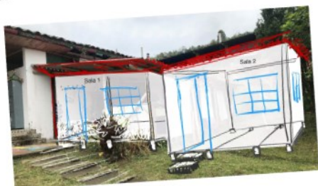
Salones 1 y 2 Primera etapa: cimentación y preparación del terreno Áreas 5 metros de frente por 9 metros de fondo
